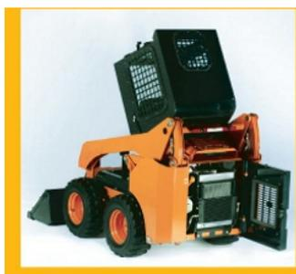
Все фронтальные ковшевые погрузчики сконструированы с учетом возможности проведения быстрого и несложного обслуживания. Полностью наклоняемые кабины с системой защиты от опрокидывания и от падающих предметов, задние дверцы, легко снимаемые без инструмента, - все это обеспечивает превосходный доступ для ежедневных осмотров и планового техобслуживания. Оператор имеет легкий доступ к очистителю воздуха, двигателю, насосу и другим основным компонентам.
